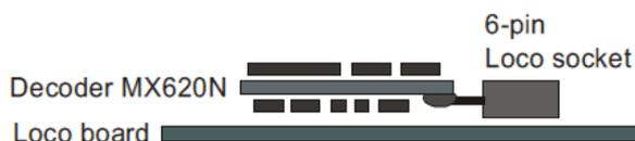
第 39 図 プラグが直接 6 ピンのインタフェースとなっている場合
